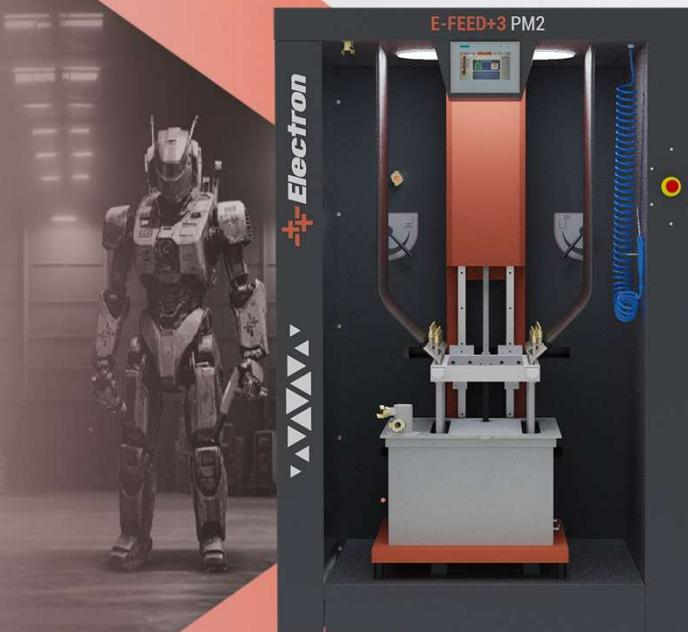
Die **Pulverzentren** der **PM2-Serie** wurden für Anwendungen entwickelt, bei denen ein **halbautomatischer Farbwechsel** erforderlich ist. Sie gewährleisten **schnelle Reinigung**, einen **effektiven und homogenen Pulvertransfer** und werden zusammen mit **Filtergruppen** als **leistungsstarkes Absaugsystem** eingesetzt.
