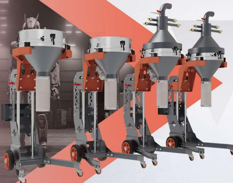
Die **E-FEED+3 MS-Serie** ist ein **mobiles Pulver-Siebsystem**, das direkt beim Anwender oder über ein Rückgewinnungssystem eingesetzt werden kann.
